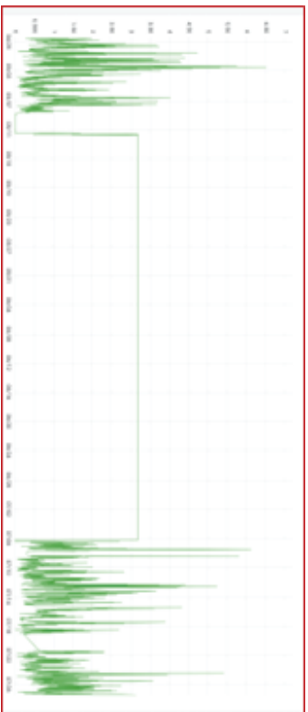
Figure 4. Enregistrement d'un anémomètre défectueux.
