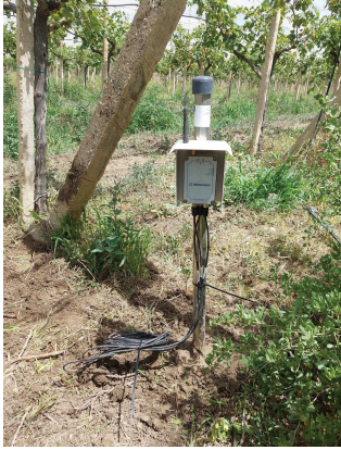
مسبار قياس رطوبة التربة على مستويات عمق مختلفة
